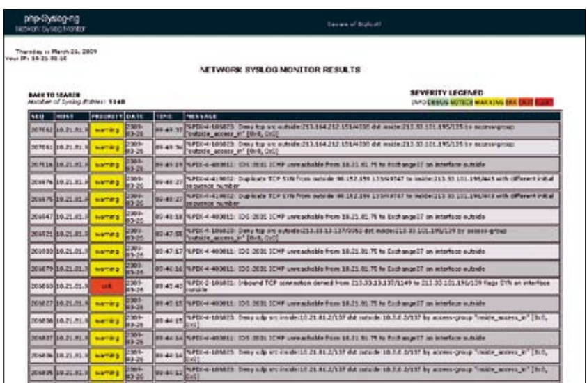
Abbildung 3: Die Meldungen der Pix-Firewall sind auf dem Linux-Server angekommen. Der Syslog-NG-Dienst hat sie in eine MySQL-Datenbank geschickt, wo PHP-Syslog-NG eine einfache, aber flotte Oberfläche mit Suchfunktionen bietet.
